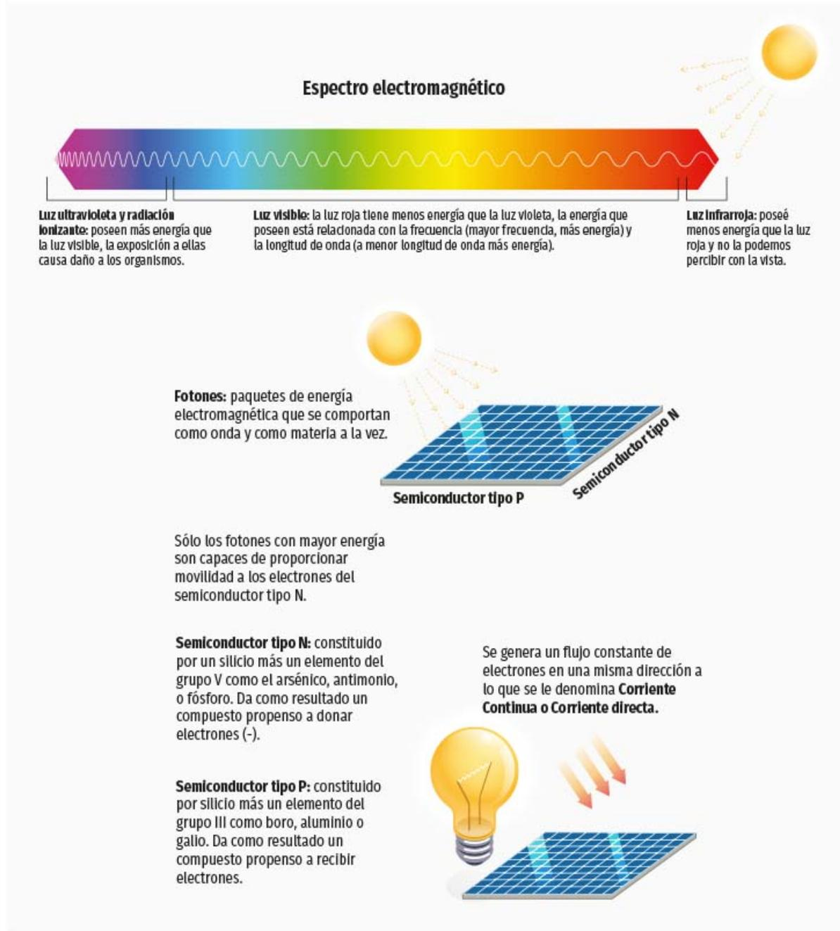
En la actualidad, la eficiencia de los paneles solares comerciales se sitúa entre 21% y 24%. Sin embargo, se está trabajando en el desarrollo de células solares que alcanzan una eficiencia de 26% a 27%, acercándose a su eficiencia máxima teórica de 29%.
